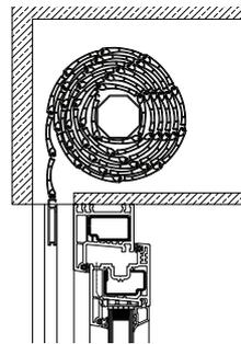
El **SISTEMA TRADICIONAL**, no requiere cajón como tal, pues los componentes y el tejido de la persiana se registran en el muro (cajón registro de obra). Supone por tanto mayor obra, realizando un hueco en el muro para el registro de la persiana.
